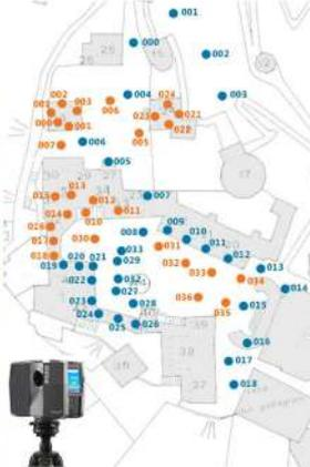
Scansioni effettuate, FARO Focus 3D. Risoluzione 1pt/5mm @ 10m.
